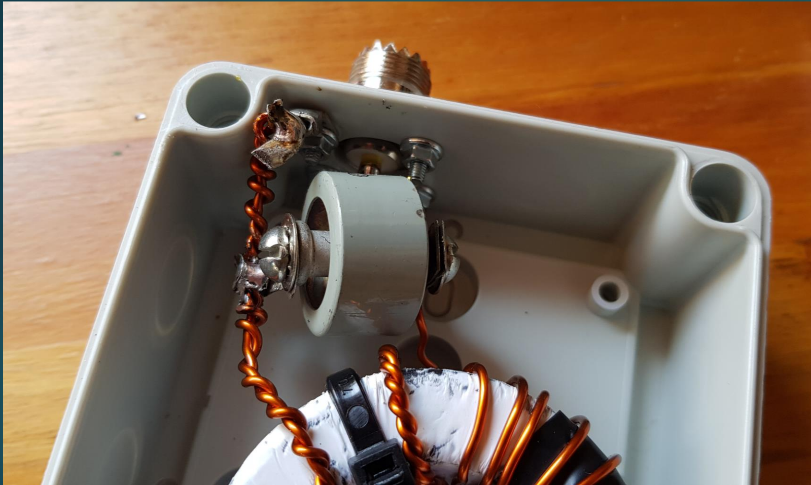
Der 100pF-Kondensator wird zwischen Innenleiter und Masse verbaut
