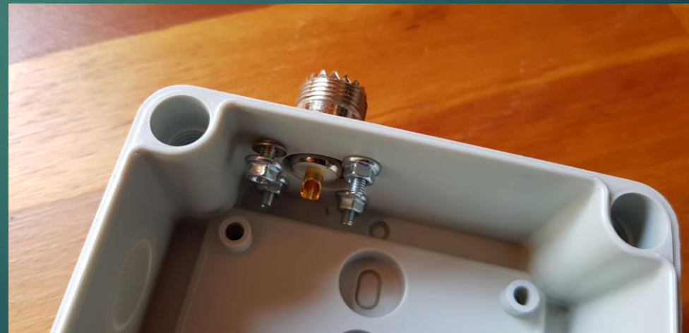
Das Gehäuse wird gebohrt und die PL-Buchse verschraubt
