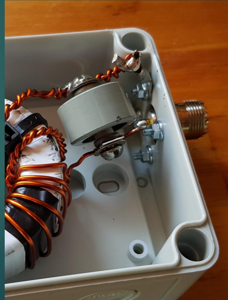
Der 100pF-Kondensator wird zwischen Innenleiter und Masse verbaut
