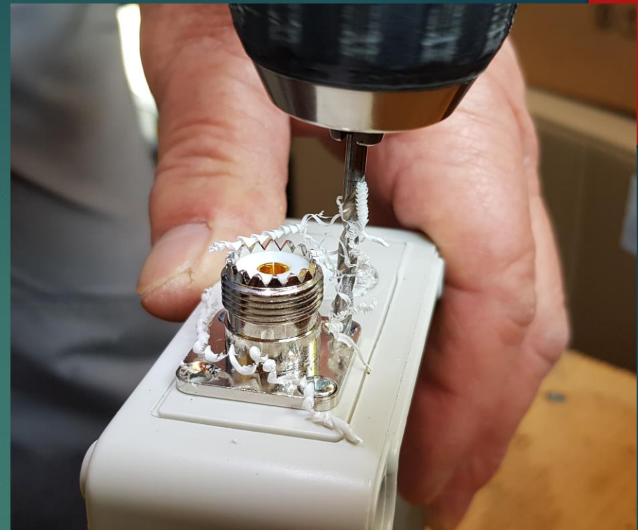
Das Gehäuse wird gebohrt und die PL-Buchse verschraubt
